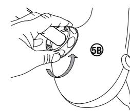
6. Pour régler l'angle de la douchette de type rideau d'eau, il suffit d'appuyer sur la tête vers le haut ou vers le bas à la position souhaitée. La tête s'emboîte.
