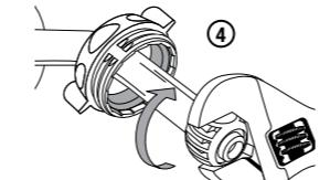
4. Con una llave ajustable o pinzas, apriete la bola de pivot dándole ¼ a ½ vuelta de giro adicional. Envuelva la bola de pivot con un paño si está usando pinzas.
