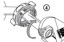
4. Serrer la boule d'articulation d'un quart à un demi-tour supplémentaire à l'aide d'une clé à molette ou d'une pince. Envelopper la boule d'articulation dans un chiffon si l'on utilise une pince.
