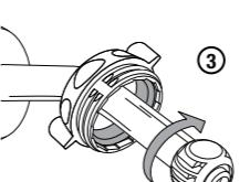
3. Enfiler la boule d'articulation sur le tuyau de douche et serrer fermement à la main pour bien l'ajuster.
