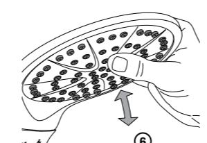
6. Para regular el ángulo del aspersor, simplemente jale el cabezal hacia arriba o hacia abajo para colocarlo en la posición deseada. El cabezal hará un chasquido al encuadrarse en su lugar.
