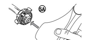
5. Sostenga el collarín rosado del cabezal de ducha contra la bola de pivot (5A), ajuste el cabezal de ducha a la posición deseada y apriete la tuerca en el sentido de las agujas del reloj hasta que quede ajustada. (5B)
