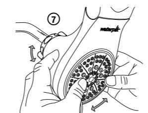
7. Para ajustar la dirección de rociado del montaje fijo, sostenga el montaje fijo con ambas manos y gírelo hacia arriba o hacia abajo sobre la bola de pivot.
