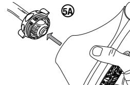
5. Placer le collier fileté de la douchette contre la boule d'articulation (5A), régler la douchette à la position souhaitée, puis serrer l'écrou dans le sens horaire jusqu'à ce qu'il ne tourne plus librement. (5B)
