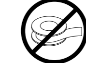
L'utilisation d'adhésif à tuyauterie n'est pas recommandée.
