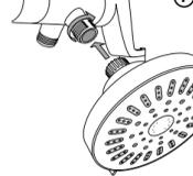
8. Installer la douchette fixe en vissant le pivot articulé sur l'inverseur. Serrer fermement avec la clé. **Ne pas serrer de manière excessive.**
